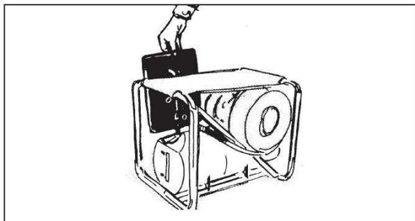
La poignée du plateau a une forme spéciale : elle vient en effet se placer entre le cadre-support et le réservoir. Faites glisser le plateau en position - la poignée se trouvant contre le réservoir, et le raccord fileté étant dirigé vers la base.
