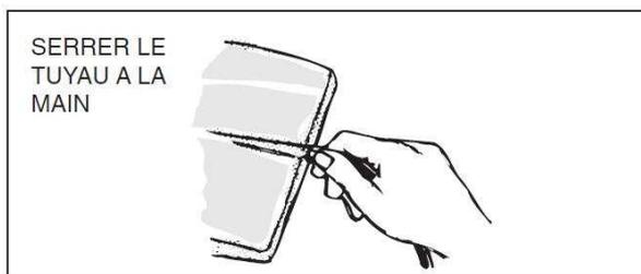
**NE PAS SERREZ DE FACON EXCESSIVE.** Si la plaque à vapeur est munie d'un joint pivotant métallique, bloquer l'écrou du tuyau à l'aide de deux clés. Par la suite, la plaque peut rester attachée au tuyau.
