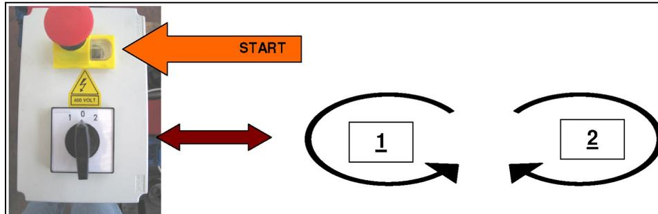
Si tel n'est pas le cas, couper l'alimentation électrique et inverser 2 phases sur la prise jusqu'à l'obtention du sens de rotation désiré.
