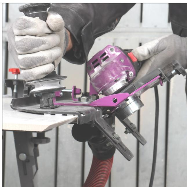
✓ Si le biseau n'est pas parallèle, reprendre le réglage du disque diamant via les 2 molettes noires.
