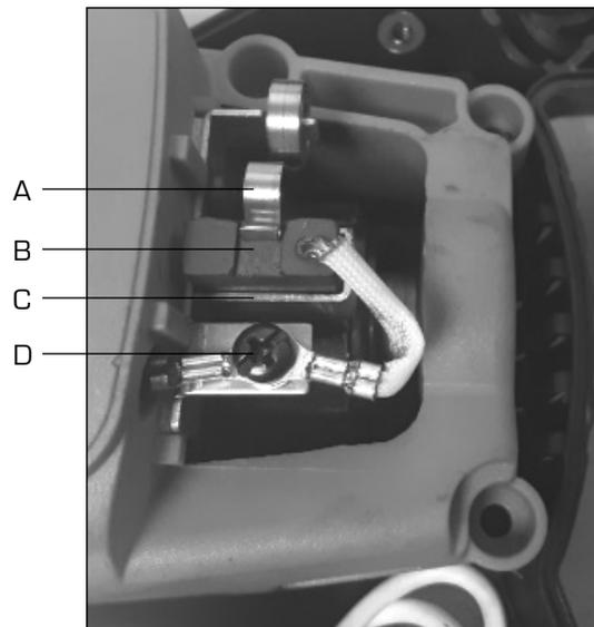
✓ Cette machine est équipée de charbons moteur à arrêt automatique. Si la machine s'arrête de manière inattendue, les charbons moteur doivent être contrôlés.
