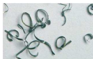
Des copeaux très fins ou poudreux indiquent une avance insuffisante
