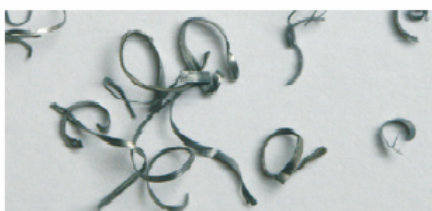
Des copeaux très fins ou poudreux indiquent une avance insuffisante
