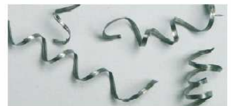
L'enroulement modéré des copeaux indique des conditions de coupe correctes
