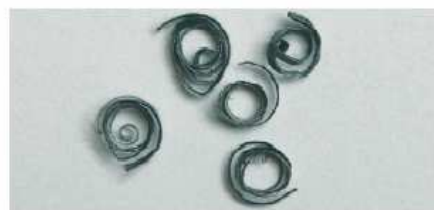
De gros copeaux à enroulement très serré ou présentant des nuances bleu-tes signalent une avance trop élevée
