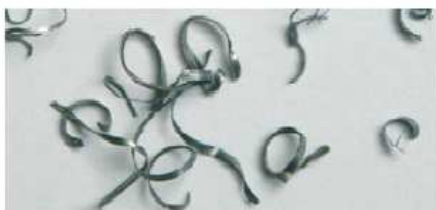
Des copeaux très fins ou poudreux indiquent une avance insuffisante
