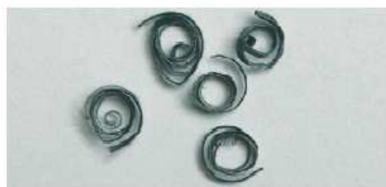
De gros copeaux à enroulement très serré ou présentant des nuances bleu-tes signalent une avance trop élevée
