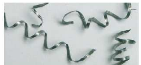
L'enroulement modéré des copeaux indique des conditions de coupe correctes
