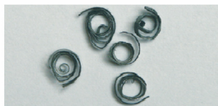
De gros copeaux à enroulement très serré ou présentant des nuances bleu-vertes signalent une avance trop élevée
