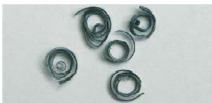
De gros copeaux à enroulement très serré ou présentant des nuances bleu-tées signalent une avance trop élevée
