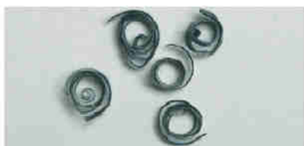
De gros copeaux à enroulement très serré ou présentant des nuances bleu-tées signalent une avance trop élevée
